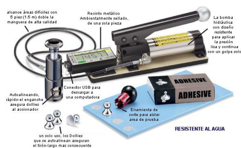
Figura 4: Dispositivos utilizados no método pull-off para teste de aderência de revestimentos
