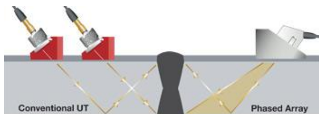
Figura 17 – Ultrassom Convencional e Ultrassom Phased Array
