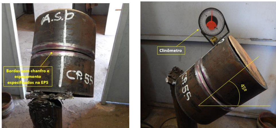
Figura 6: Segmentos de tubos preparados conforme EPS e montados na posição 6G
