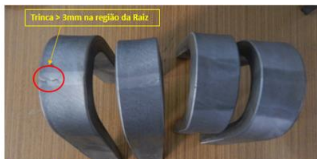
Figura 12 – Exemplo de Corpos de prova reprovados após inspeção visual.
