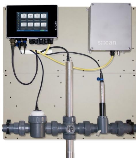
Figura 7- Equipamento para medição de DQO on-line.
