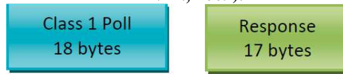
Figura 10: Pacote de reporte da Classe 1 sem eventos no protocolo DNP3 com o método 3 (FONTE: BEVIN, 2009).
