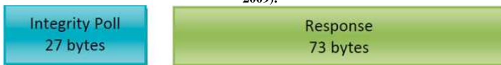
Figura 7: Pacote de leitura de integridade no protocolo DNP3 com o método 3 (FONTE: BEVIN, 2009).
