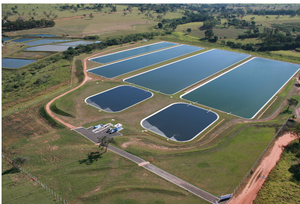
Figura 1. Fotografia aérea de Lagoas Anaeróbias seguidas por Facultativas e Maturação
