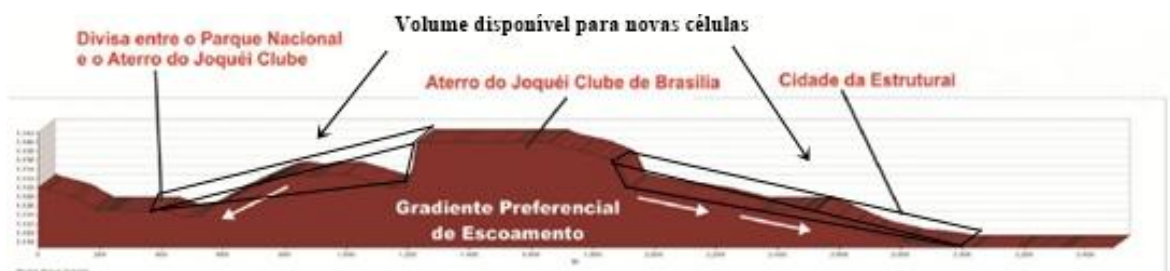
Figura 8 – Volume disponível - Perfil topográfico do Aterro JCB no sentido Norte – Sul, visada para leste (CAVALCANTI, 2013 - modificado).
