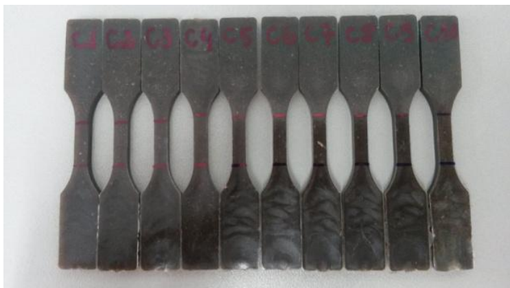
Figura 5: Corpos de prova do compósito para ensaio de tração.
