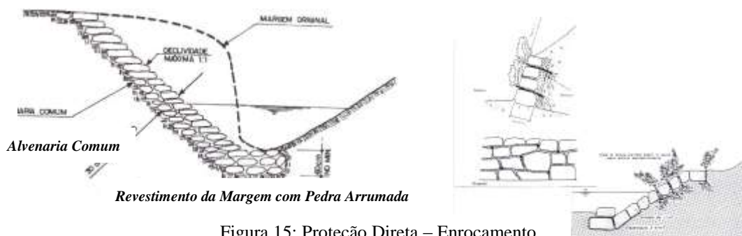
Figura 15: Proteção Direta – Enrocamento Fonte: SILVA, (2004)
