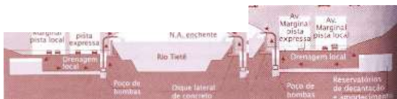
Figura 16: Polder na Ponte das Bandeiras. Fonte: CANHOLI (2005).
