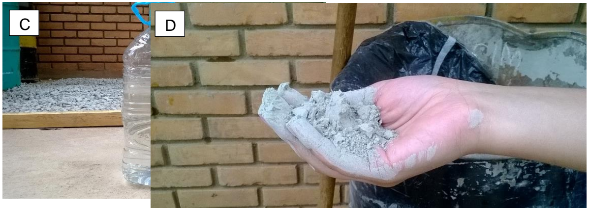
Figura 1. Materiais utilizados para a fabricação dos concretos: (A) respectivamente: brita gnaiss N o 01, pó de brita e areia; (B) efluente coletado de indústrias do segmento têxtil; (C) água potável; (D) cimento Portland.
