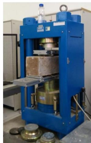
**Figura 3:** (A) Medidas do corpo de prova prismático; (B) Ensaio de resistência a tração na flexão.
