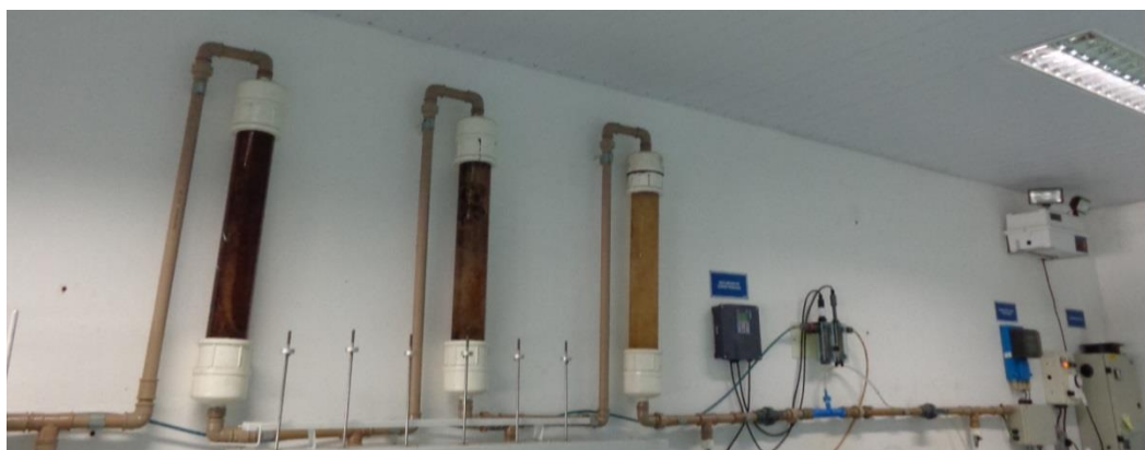
Figura 1. Sistema piloto de ozonização instalado nas ETA 3 e 4 da SANASA.
