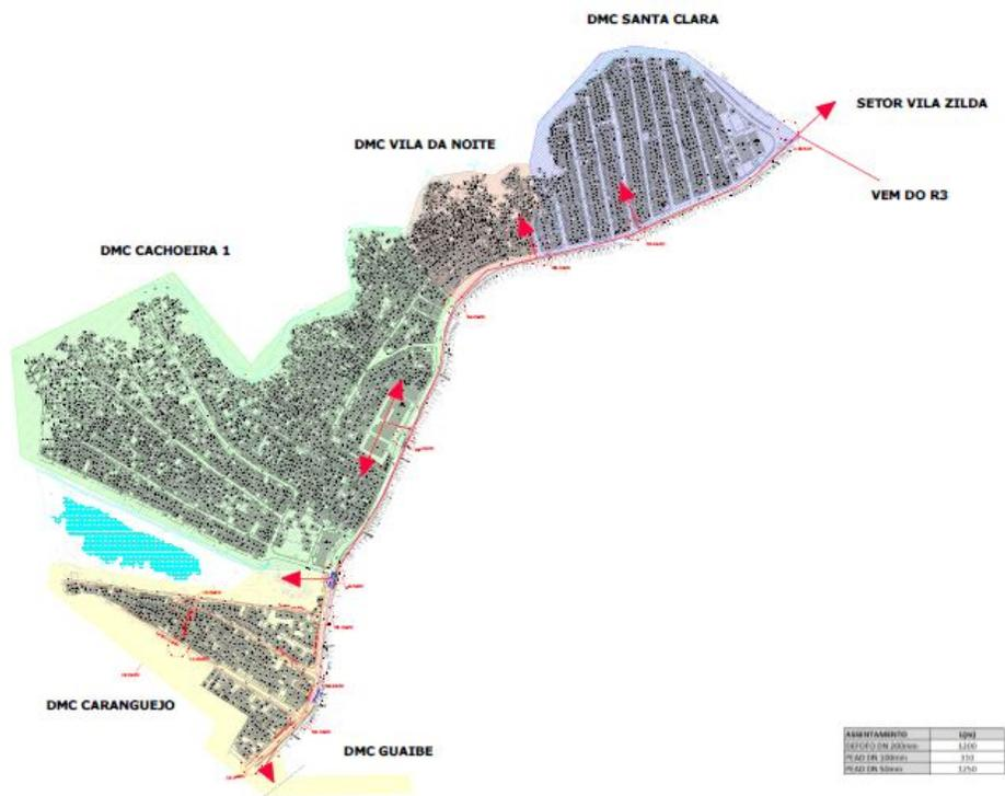
**Figura 3** – Ações estruturantes: Reforço de rede e distritos pitométricos projetados para a região da Cachoeira Baixa (Primeira etapa)
