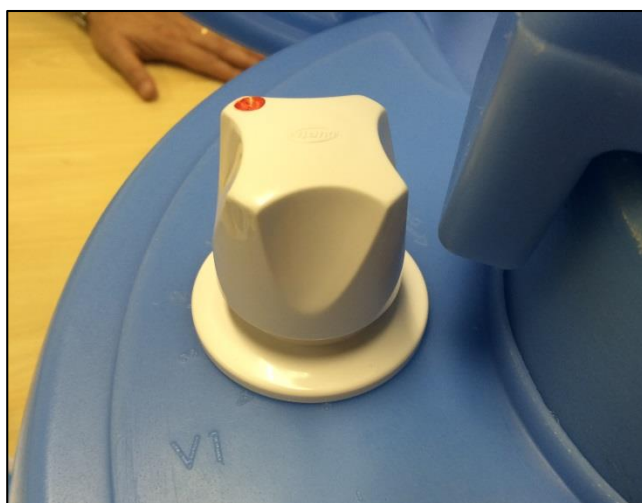
Figura 3: Válvula que ajusta a dosagem de cloro aplicada pelo dosador hidráulico.
