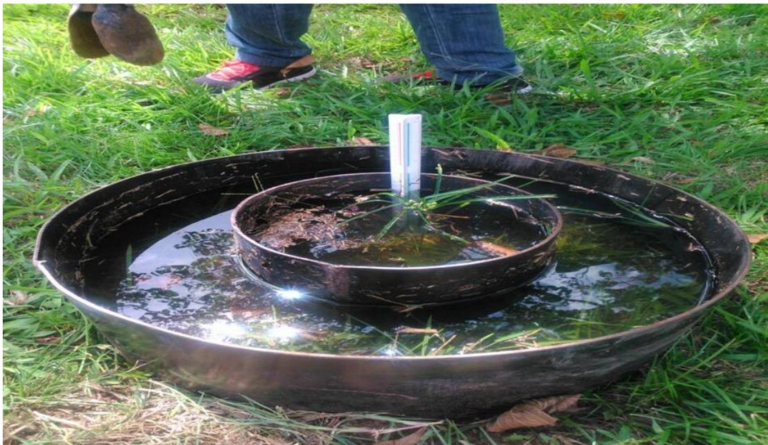
**Figura 11: Valores do teste de infiltração no ponto 3, dentro da zona semipermeável. FONTE: Autores, 2014.**
