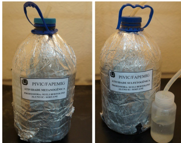
Figura 2: Reator de adaptação para bactérias metanogênicas (A) e bactérias sulfetogênicas (B).
