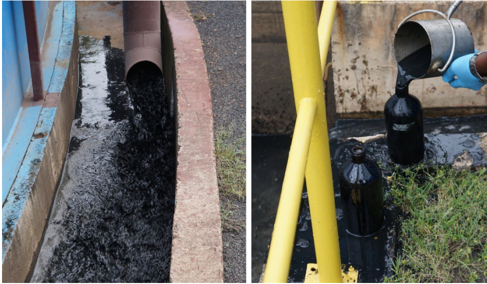
Figura 1: Canal de passagem de lodo (A); coleta de lodo de inóculo na ETE Uberabinha (B).
