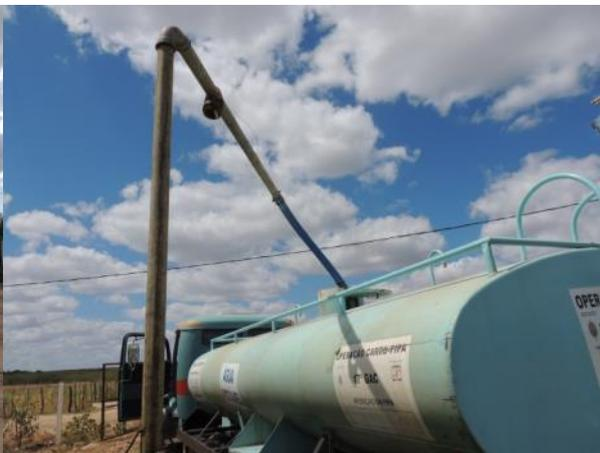
Em Afonso Bezerra, o abastecimento por Carro-Pipa é realizado através de 3 caminhões-pipa, sendo dois com capacidade de 9m<sup>3</sup> e um com capacidade de 8m<sup>3</sup>, tendo sido contratado para tal finalidade três Pipeiros. No total, tem-se a distribuição de 154 carradas de 9 m<sup>3</sup> e 94 carradas de 8m<sup>3</sup> cada, totalizando 2.138 m<sup>3</sup> de água distribuídos mensalmente para a população rural do município de Afonso Bezerra, pela Operação Carro-Pipa.
