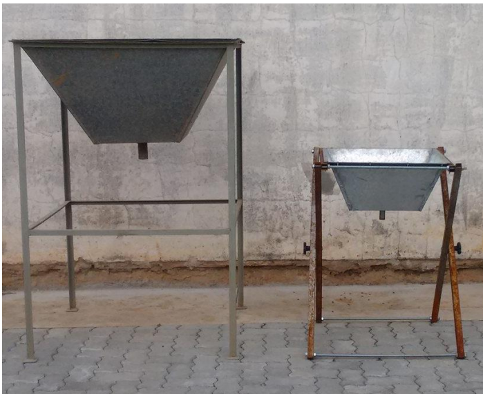
Figura 1: Leito de Drenagem desenvolvido por Cordeiro (2001) e protótipo em escala reduzida utilizado na pesquisa.
