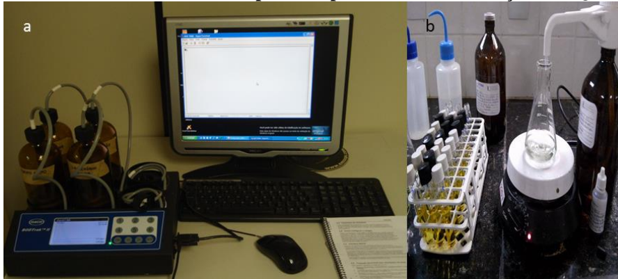
Figura 03: Apresentação das metodologias e equipamentos dos procedimentos laboratoriais. Em a: transferência de dados do BOD Hach TM II para computador. Em b: Titulação da DQO.
