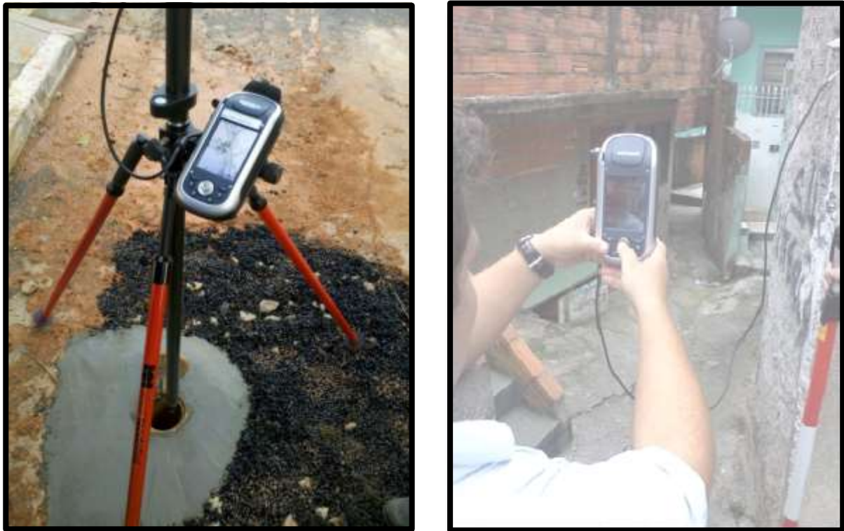
Figura 2 - Georreferenciamento com o coletor geodésico
