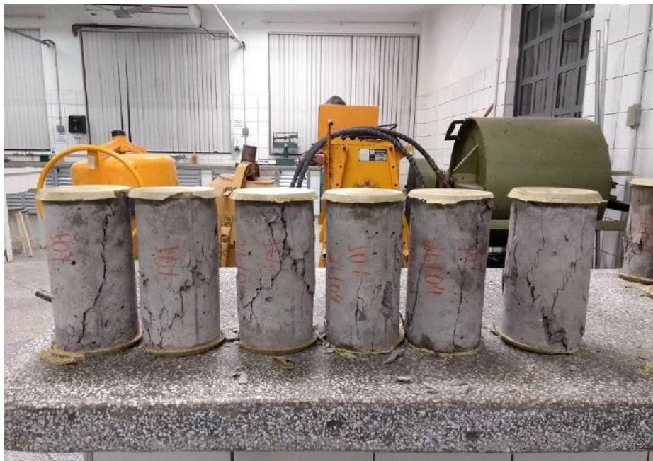
Figura 05 – Corpos de prova com 10% de substituição com lodo após ensaio de compressão simples.
