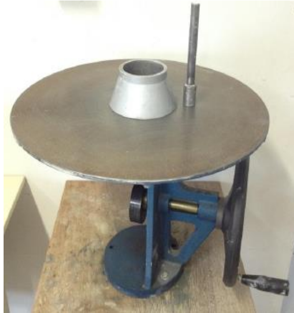
Figura 4 – Equipamentos ensaio de mesa ( flow table test )
