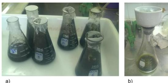
**Figura 11: a) Amostras de lama de aciaria LD fina após ensaios de solubilização em ácido clorídrico; b) filtração das amostras solubilizadas. Fonte: Autores, 2016.**
