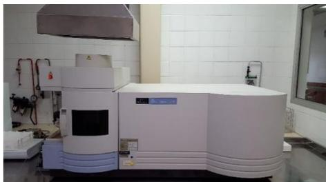
**Figura 6: Espectrofotômetro de Emissão Atômica com Plasma Acoplado Indutivamente (ICP OES).**
