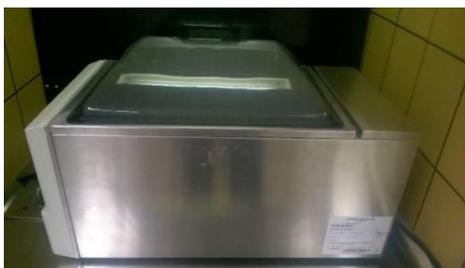
**Figura 10: Banho termostático utilizado na manutenção de temperatura durante a etapa de solubilização das amostras de lama de aciaria LD fina. Fonte: Autores, 2016.**
