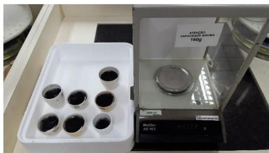
**Figura 7: Preparo da amostra de lama de aciaria LD fina para a etapa de fusão. Fonte: Autores, 2016.**
