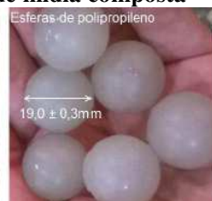
Figura 37 - Esferas de polipropileno utilizadas no ensaio de transporte de sólidos e remoção de esferas
