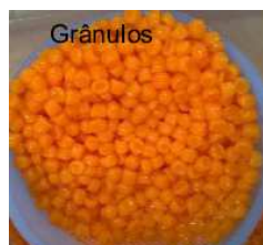
Figura 38 - Grânulos e esferas de nylon utilizados no ensaio de remoção de grânulos
