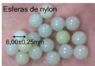
Figura 38 - Grânulos e esferas de nylon utilizados no ensaio de remoção de grânulos
