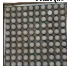
Figura 37 - Esferas de polipropileno utilizadas no ensaio de transporte de sólidos e remoção de esferas
