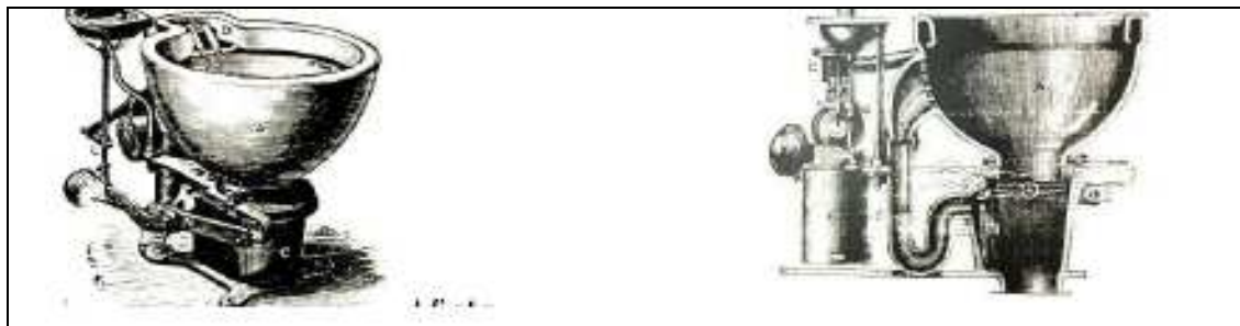
Figura 4 – Ilustração da bacia valve closet (vista e corte)
