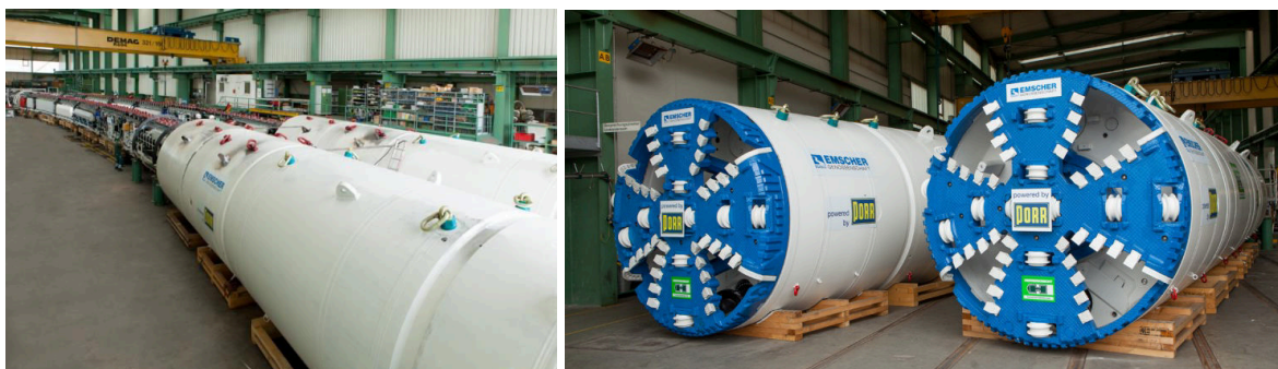
Figura 2: Máquinas EPB 2600 com DE 3.225 mm usadas na construção do coletor de esgoto Emscher.
