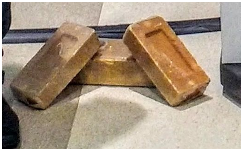
Figura 1: Tijolos Ecológicos de Solo Cimento maciços com adição de lodo de esgotos seco
