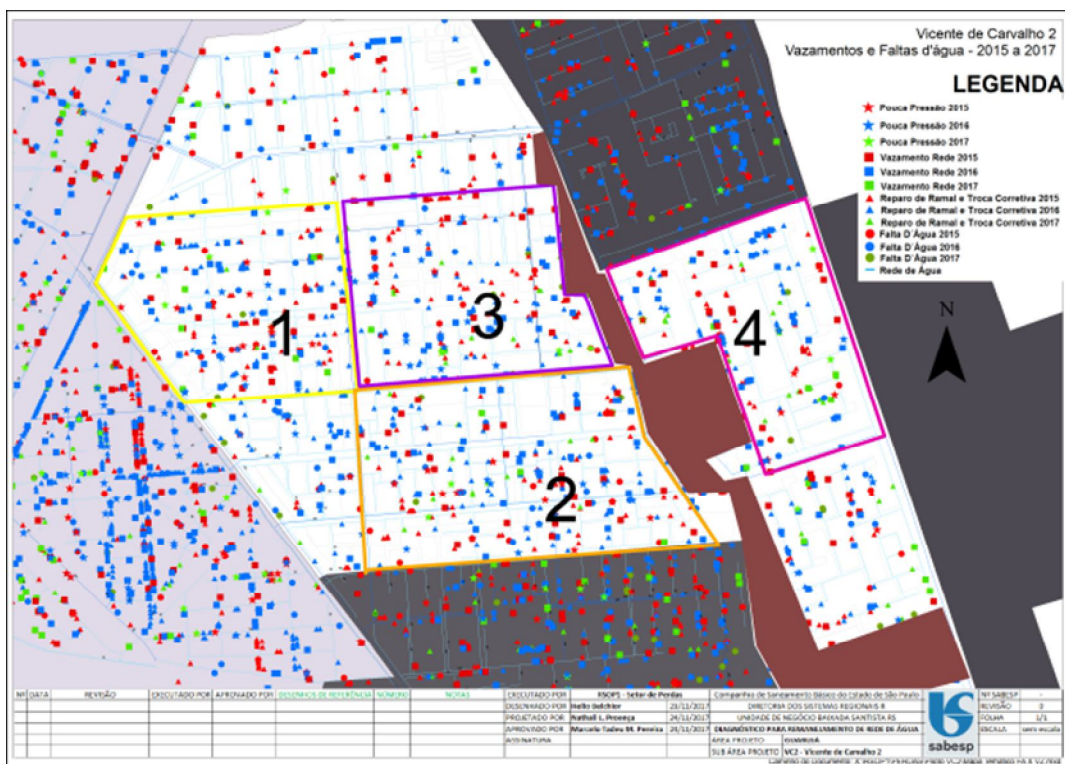
Figura 10: Vazamentos e Falta D'Água no setor VC2
