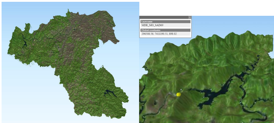
Figura 5 – Perspectiva da MO criada no QGIS: esquerda, posição geral e direita, zoom na represa de Pirapora captando coordenadas (esfera amarela e tabela cinza).
