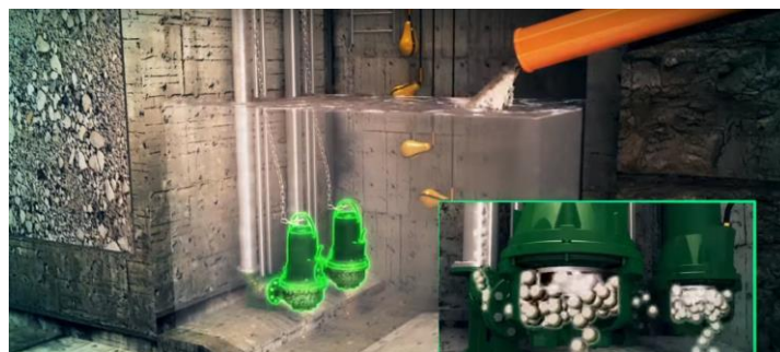
Figura 32 – Acionamento de segunda bomba através de sobrecarga na E.E.E. Fonte: Rolo & Pereira Ltda
