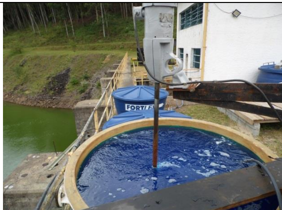
Figura 5: Misturador com hélice de motor de popa de barco e caixa de 2000L utilizada para preparação da solução de Sulfato de cobre.
