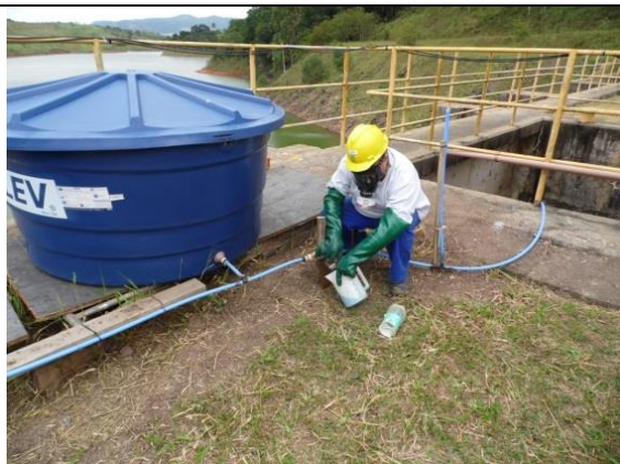
Figura 6: Medição da vazão de solução do algicida.
