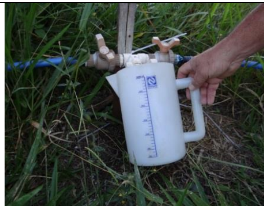
Figura 7: Registro utilizado para medir a vazão de aplicação da solução do algicida.
