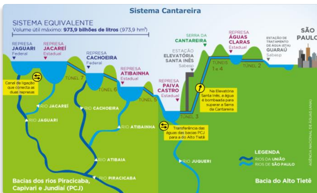
Figura 1: Reservatórios que compõem o Sistema Cantareira.
