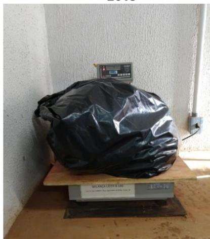
**Figura 1: Recipiente e balança utilizados na determinação dos volumes e pesos dos resíduos sólidos gerados nas Escolas de Engenharia.**
