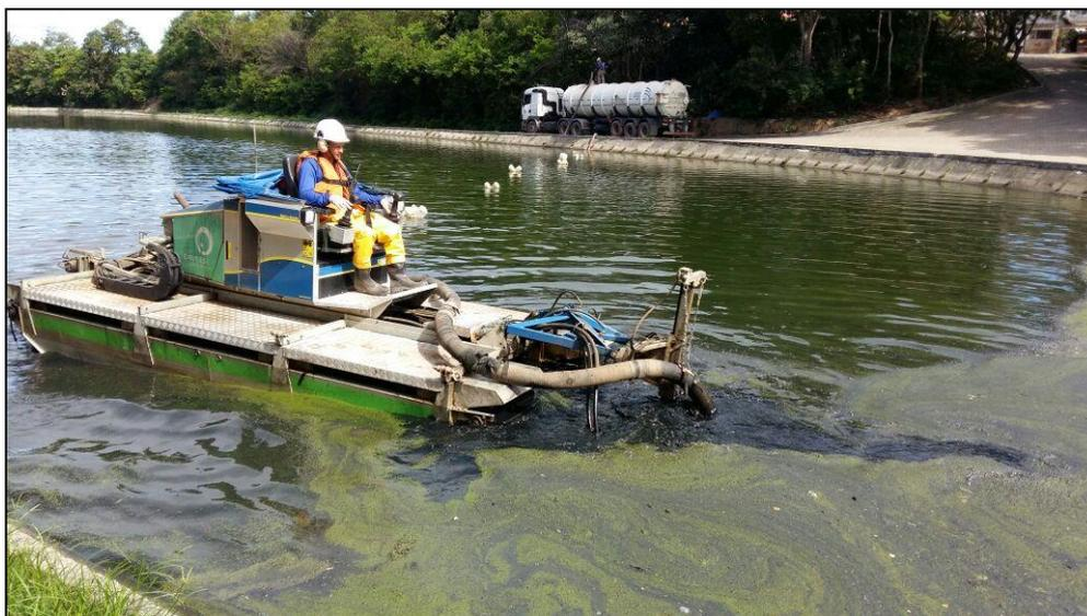
**Figura 3 - Operação de dragagem de lodo na ETE.**
