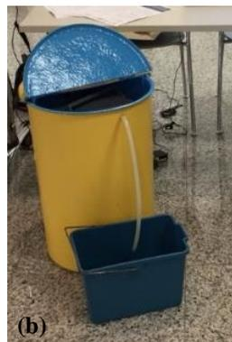
**Figura 1: Representação esquemática (a) e foto da versão cabeça de série do Amostrador Étsus 1000 (b)**
