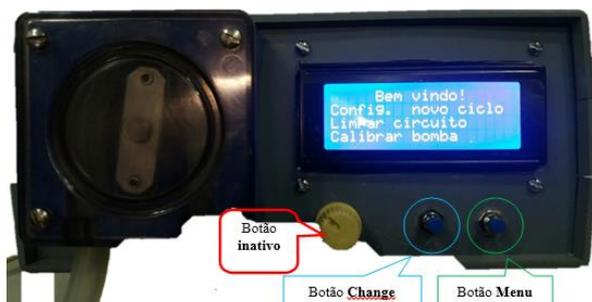
**Figura 2: Representação dos botões funcionais e inativo do equipamento.**
