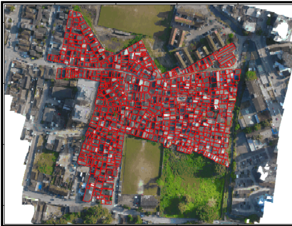
Figura 19. Contagem computacional utilizando lógica em software ArcGis no núcleo Pantanal em Santos.
