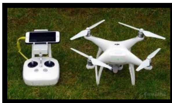
Figura 4 – Equipamento drone ou VANT (veículo aéreo não tripulado) utilizado nas filmagens e fotografias.
