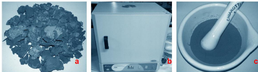
Figura 1 - Sequência de preparação da matéria prima a) fragmentação do lodo, b) secagem e c) moagem do lodo.
