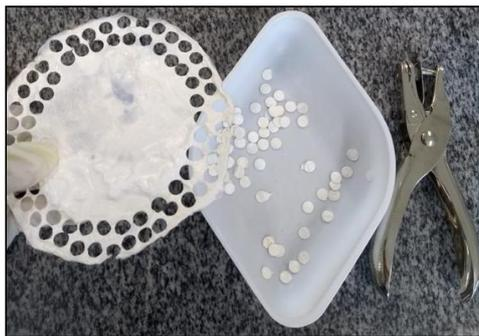
**Figura 7: Celulose bacteriana liofilizada com o corte padrão.**
