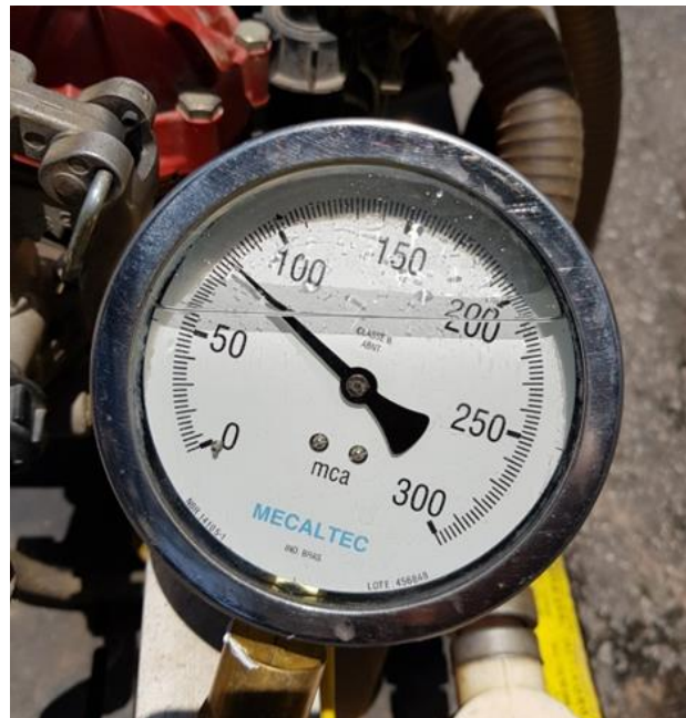
Figura 5: Pressão registrada após a etapa de estabilização.
