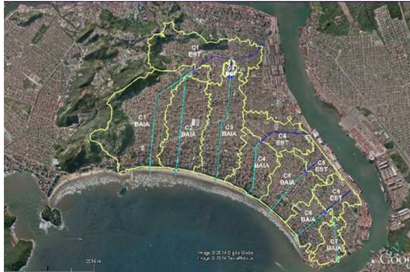
Figura 2: Definição das áreas de drenagem (amarelo) dos 7 principais canais artificiais de Santos (C1 a C7 da esquerda para a direita). Fonte: Estudo hidrológico preliminar de Santos/SP (RAMOS JÚNIOR, 2014). Em verde e azul, trechos dos canais que drenam para a Baía e Estuário, respectivamente.
