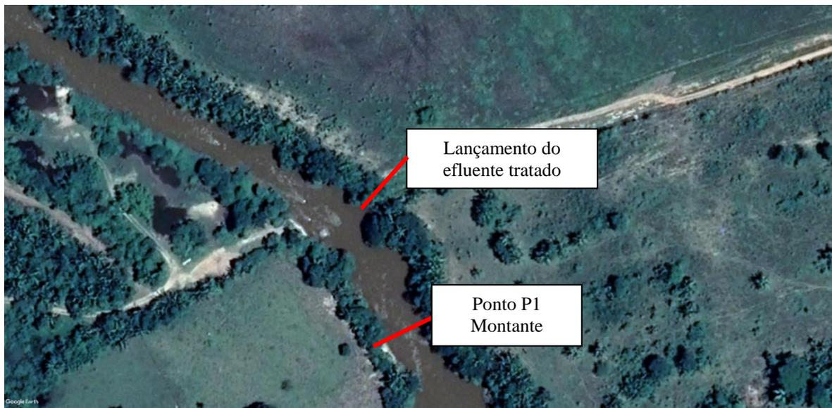
**Figura 2: Ponto de lançamento do efluente tratado e Ponto de coleta de amostras do rio**
