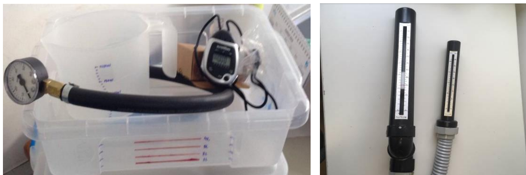
Figura 1. Kit de medição e medidor de vazão de vazamento
