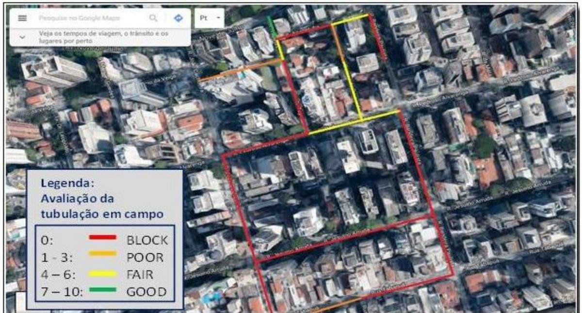
**Figura 2 - Mapeamento das condições das redes de esgotos**
