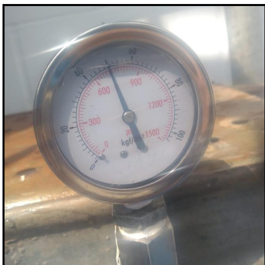
Figura 22 – Teste hidrostático do conjunto montado
