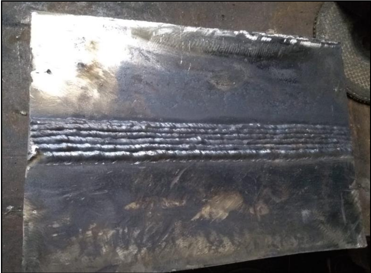
Figura 15 – Corpo de prova de certificação dos procedimentos e qualificação dos processos de soldagem
