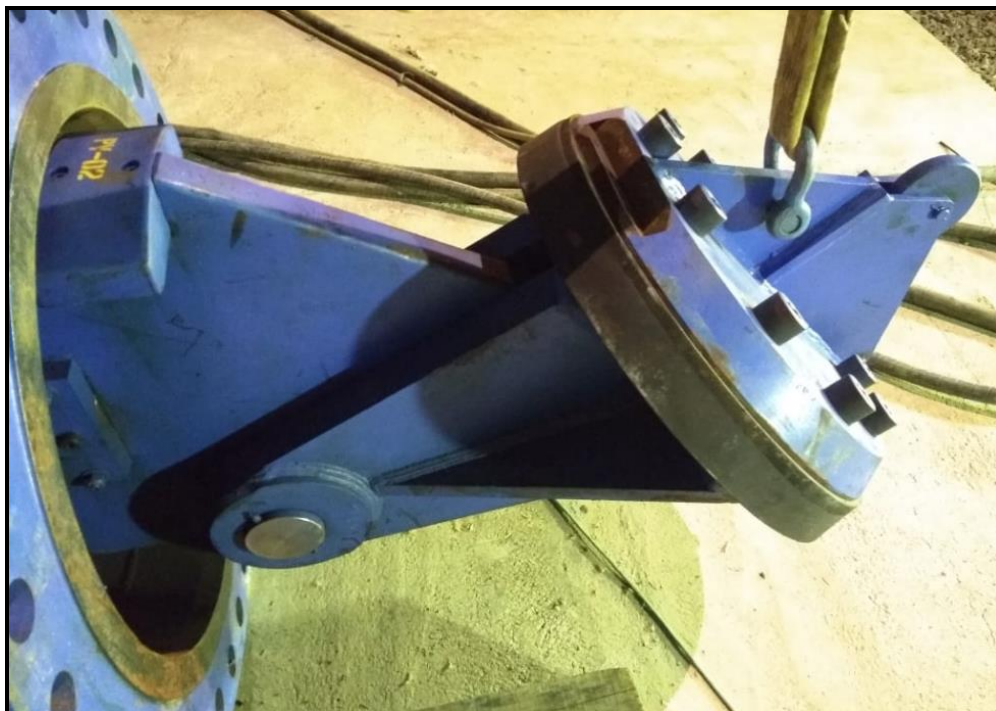
Figura 26 - Braço articulável de bloqueio pronto para ser instalado e inserido
