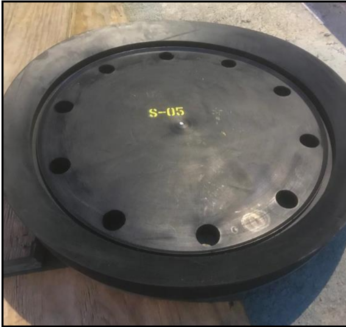
Figura 24 - Vedação em borracha nitrílica (Buna N) específica para a vedação.
