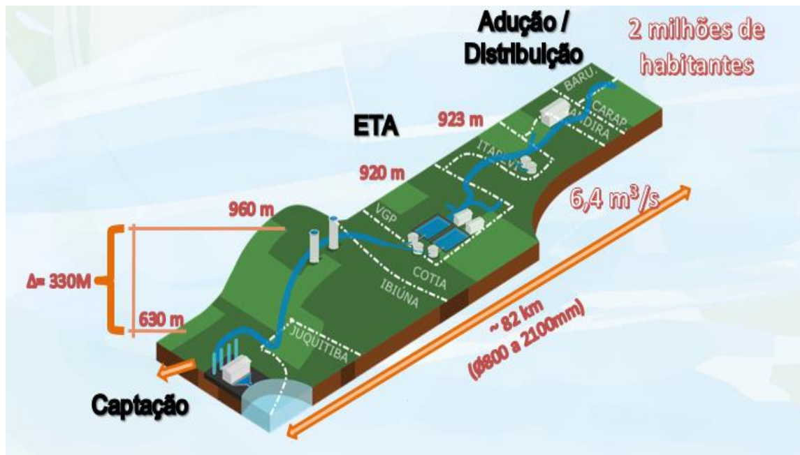
Figura 1 – Esquemático de Adução e Distribuição do SPSL
