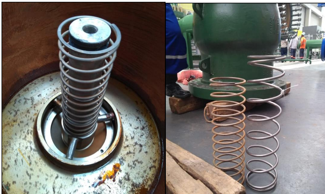
Figura 24 – Nova mola de 1.400N já trocada (vista interna da válvula) e a diferença visual entre a mola de 250N e a de 1.400N.
