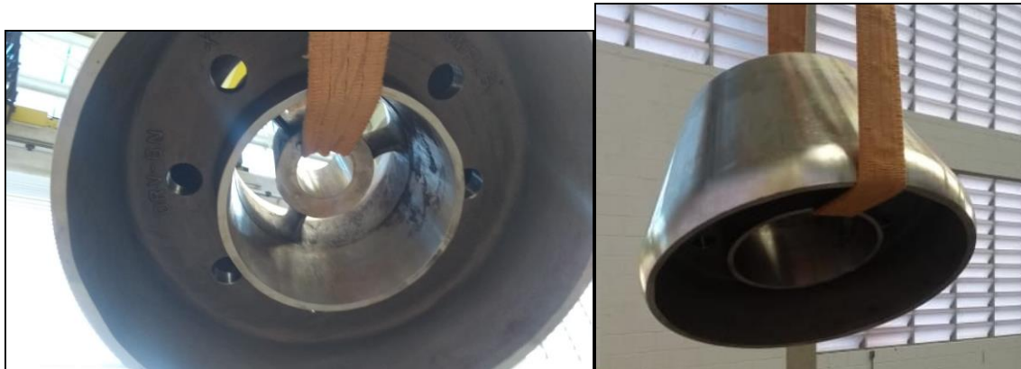
Figura 26 – Furação realizada no “Nozzle” da válvula para se evitar o efeito “copo sobre copo” que gera vácuo impeditivo de fechamento da válvula de retenção.
