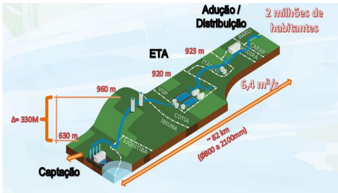
Figura 1 – Esquemático de Adução e Distribuição do SPSL
