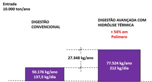
**Figura 21:** Comparativo de Demanda anual de Polímero entre Digestão Convencional e Digestão Avançada com Hidrólise Térmica – “WAS Only” para um Fluxo de Lodo de Entrada de 10.000 ton/ano (60% primário e 40% secundário).
