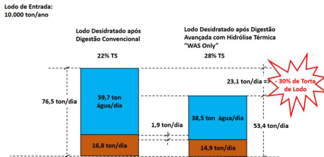
**Figura 17:** Comparativo de Produção Diária de Torta de Lodo entre Digestão Convencional e Digestão Avançada com Hidrólise Térmica “*WAS Only*”
