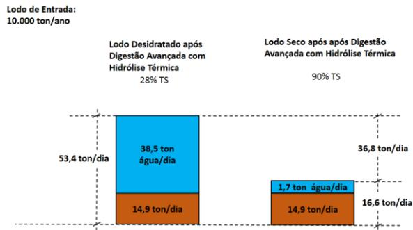
**Figura 12:** Produção Diária de Lodo em Massa Úmida para Digestão Avançada com Hidrólise Térmica
