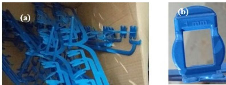
**Figura 4: Peças injetadas: (a) fixadas ao canal de injeção e (b) sem o canal de injeção**
