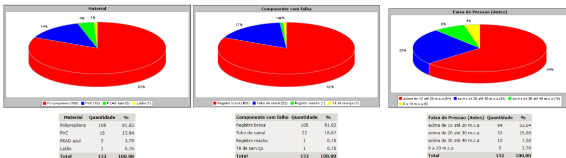
Figura 24 BSI: SRF Ramais - Tipo de Material, Local da Falha, Pressão de Serviço
