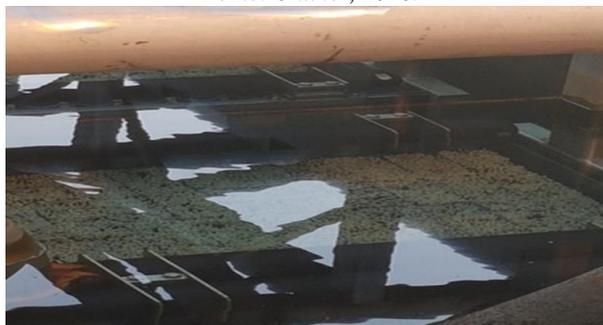
Fotografia 2- Skid com membranas submersas em água decantada
