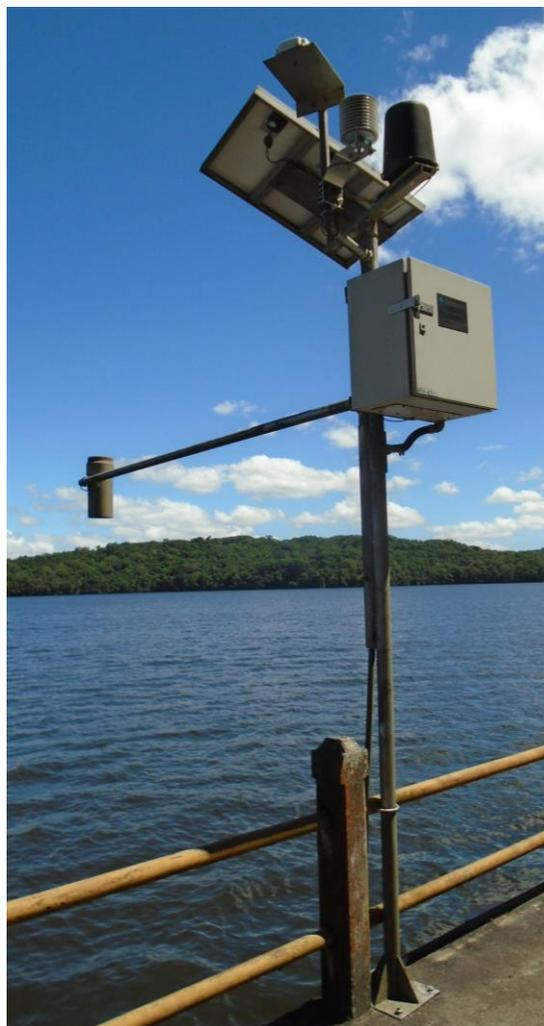
**Figura 2: Posto telemétrico (pluviômetro) da Sabesp.**
