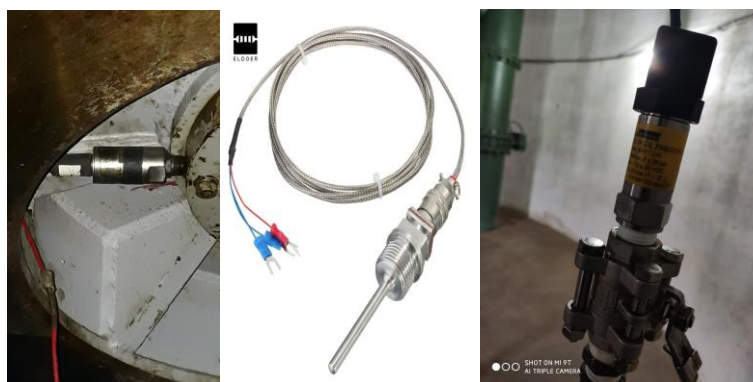
Figura 5 – sensores de vibração (a esquerda), de temperatura (centro) e de pressão (a direita).
