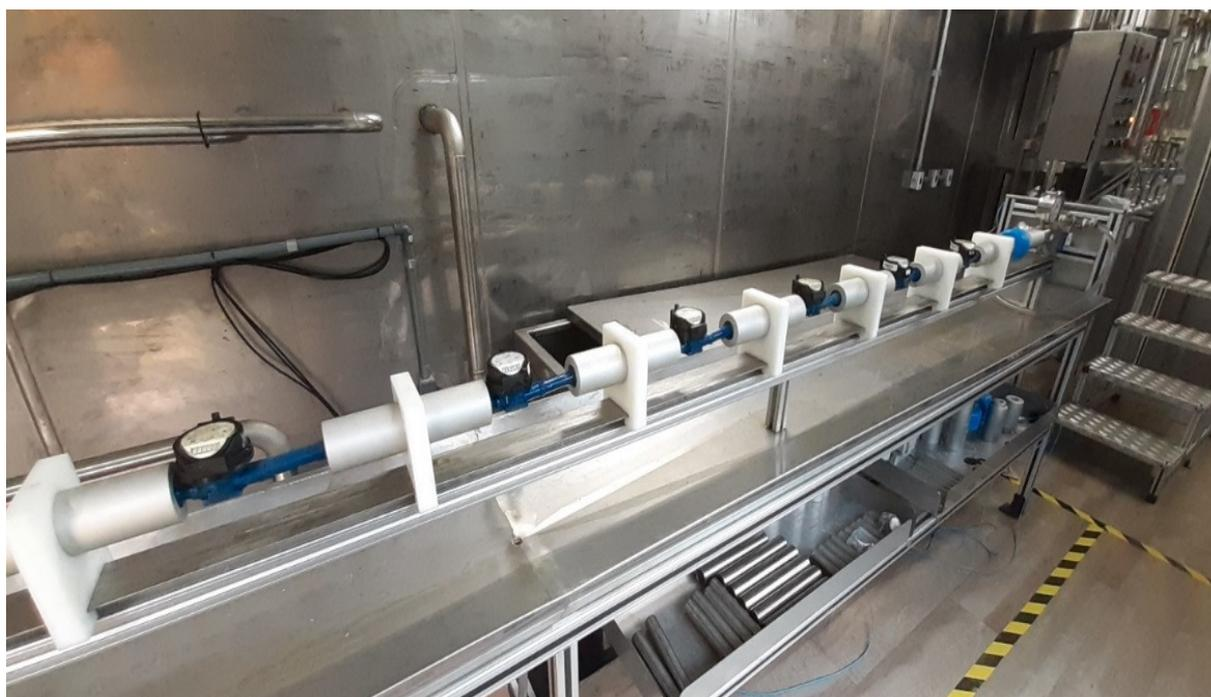
**Figura 1: Bancada volumétrica para ensaios em hidrômetros da Companhia Águas de Joinville.**
