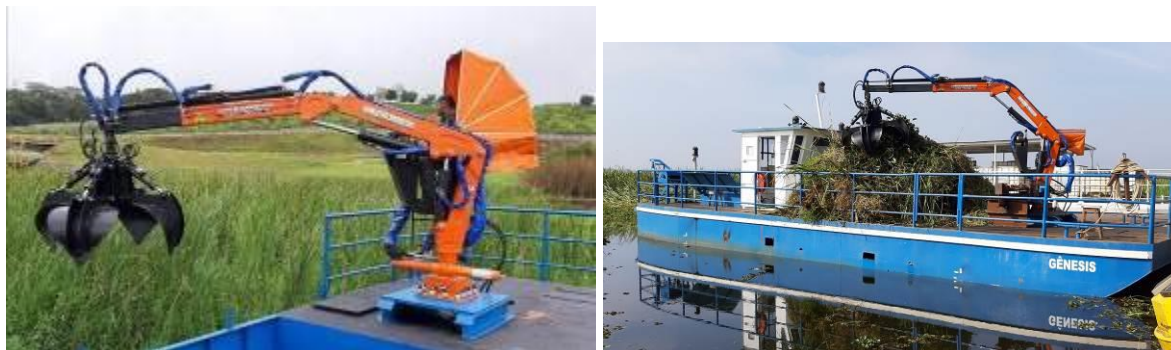
Figura 5 – Adaptação com Guincho Hidráulico.
