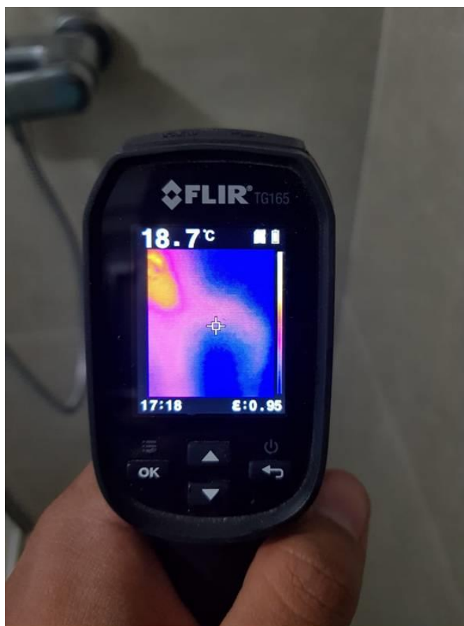
Figura 04 – Localização de Térmica de Vazamentos.
